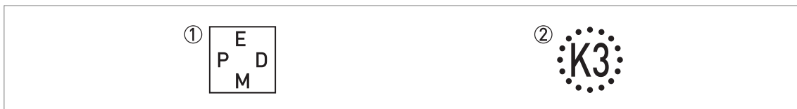
Figura 2-5: Símbolos del material de la junta suministrada (en el lado de la conexión de proceso)
